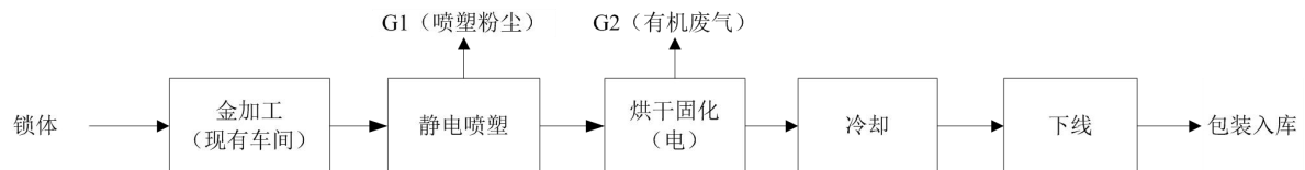
图1-6 挂锁锁体喷塑加工生产工艺流程及产污环节示意图
